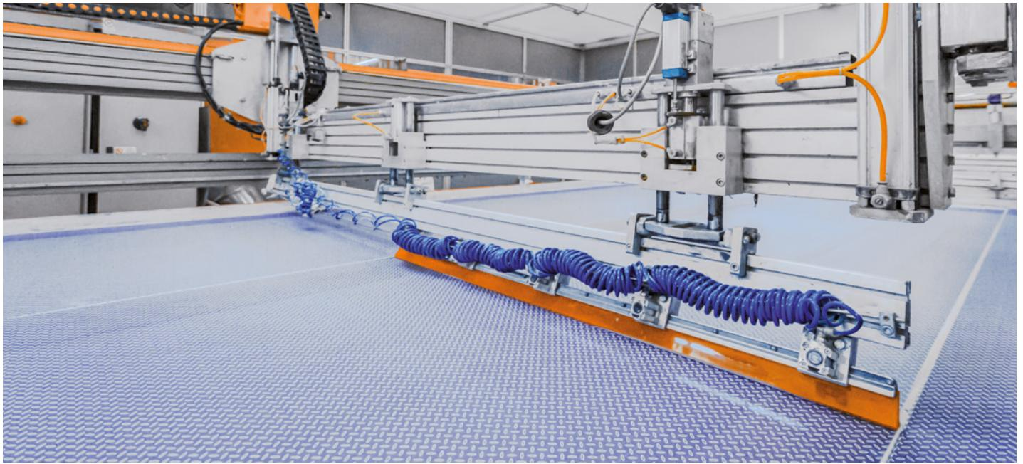
Proceso que consiste en aplicar pintura cerámica a un vidrio claro o de color en una de sus caras y posteriormente se garantiza su adherencia a la superficie a través del proceso de templado. El resultado es un vidrio de excelente calidad, estética y funcionalidad,
